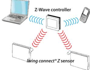
*living connect*® Z leveres med adaptere til Danfoss RA-ventiler og ventiler med M30 x 1,5 (K)-tilslutninger, 2 stk. AA alkaline batterier og en 2 mm unbrakonøgle.
